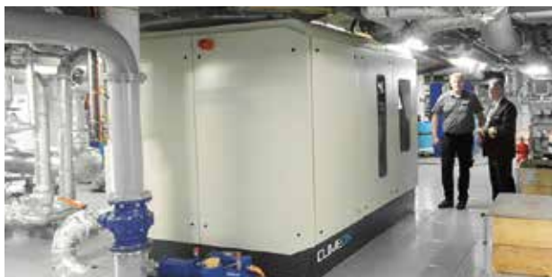
Viking Grace är första fartyg att använda det nya energiåtervinningssystemet Ocean Marine.
